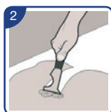
Škrabkou odstraňte zaschlou a připečenou mastnotu.
